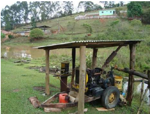
Figura 70 – Captação para a irrigação de olerícolas.
